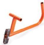
Handwerkzeug zum Fräsen von Nuten für die Fugenbewehrung und Schlitzen für elektrische Leitungen. Die Fräsklinge ist 20 mm breit, die maximale Tiefe beträgt 40 mm.
