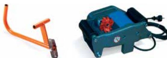
Outil manuel pour le fraisage de rainures pour le renforcement des joints et l'installation de câbles électriques.
