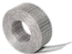
Murfor est utilisé pour renforcer les constructions en maçonnerie. Le renfort de maçonnerie Murfor® Compact-A est une maille de câbles d'acier en rouleaux. Un rouleau contient 30 m de renfort et est disponible en largeur 40 et 80 mm. Le renfort des murs n'est pas obligatoire, mais si les murs en blocs dépassent 3 m, nous recommandons l'utilisation d'un renfort pour éviter la formation de fissures. Il est recommandé de fixer le renfort sur les quatre joints.
