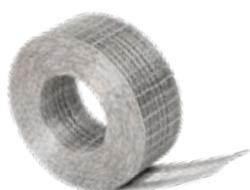
Murfor è usato per rinforzare le murature bauroc. Il rinforzo per giunti Murfor® Compact-A è una rete intrecciata in acciaio che viene fornita in rotoli. Un rotolo contiene 30m di rinforzo, sono disponibili le larghezze di 40 e 80mm. Il rinforzo delle pareti non è obbligatorio, ma se i muri in blocchi superano i 3m, consigliamo di utilizzare il rinforzo per evitare la formazione delle crepe. Consigliamo di applicare il rinforzo a ogni quarto giunto.
