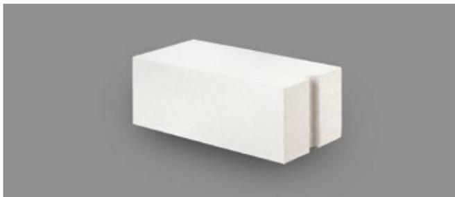
I blocchi bauroc HARD sono dei blocchi da costruzione con una resistenza a compressione pari a 5,0 Mpa. I blocchi HARD vengono usati nelle costruzioni in muratura che sono sottoposte ad un carico maggiore. I blocchi HARD possono essere usati anche per costruire i muri del seminterrato. Nei muri esterni degli edifici, i blocchi HARD richiedono un ulteriore isolamento termico.
