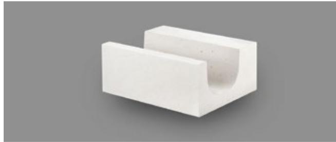
BLOCCO-U è realizzato dai normali blocchi bauroc, dove vengono intagliati dei fondelli con un profilo a forma di U. I BLOCCHI-U sono utilizzati per l'esecuzione di pilastri di irrigidimento e, se necessario, come superficie di appoggio sotto le travi del soffitto. I BLOCCHI-U sono adatti anche per la realizzazione di architravi monolitici in calcestruzzo in un cantiere edile.
