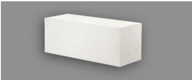
I blocchi MASCHERA bauroc hanno le dimensioni di 580x250x200 (lunghezza x altezza x larghezza) e sono prodotti realizzati con calcestruzzo cellulare con la stessa densità delle LASTRE PER SOLAI. I blocchi MASCHERA sono usati per "il riempimento" dei muri ad altezza del soffitto. Le superfici del blocco MASCHERA sono prive di scanalature.
