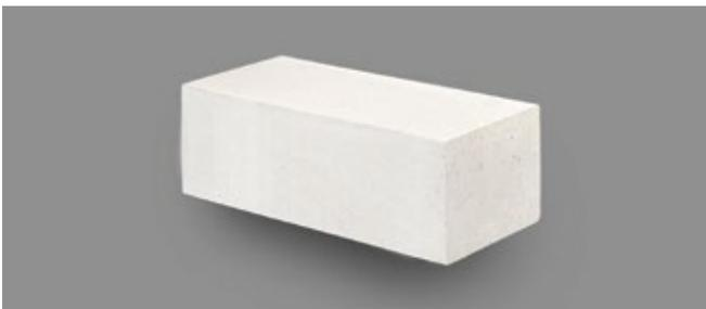
I blocchi ACOUSTIC sono quelli con la densità più alta in assoluto. I blocchi ACOUSTIC sono una buona soluzione per gli edifici, in cui bisogna impedire la diffusione del rumore da una stanza all'altra. Nei muri in blocchi ACOUSTIC spessi 250mm l'isolamento acustico è di  $R_w=49$  dB. Consigliamo i blocchi ACOUSTIC per la costruzione di muri divisorii degli appartamenti ( $R_w$  55 dB).
