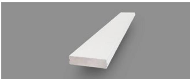
La LASTRA PER SOLAIO bauroc è concepita per essere utilizzata come un elemento portante e termoisolante per i solai, soppalchi e coperture degli edifici. I pannelli hanno il rinforzo appropriato per garantire la capacità portante delle lastre. L'altezza della lastra è di 250mm e le larghezze disponibili sono 600 e 300mm. Le lastre vengono realizzate lunghe fino a 6m\*, l'incremento della lunghezza è di 0,2m\*.
