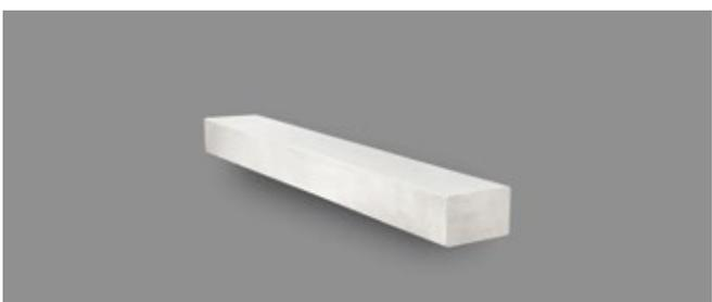
ELEMENTO SCALA bauroc è un gradino grezzo in calcestruzzo cellulare armato. Gli elementi delle scale sono prodotti da calcestruzzo cellulare con una massa volumica a secco di 500kg/m<sup>3</sup>. Dagli elementi delle scale bauroc si possono costruire sia le scale chiuse sia quelle aperte, con travi di supporto angolari. La scala costruita con i gradini in calcestruzzo cellulare è ignifuga, è silenziosa e non scricchiola scendendo le scale.
