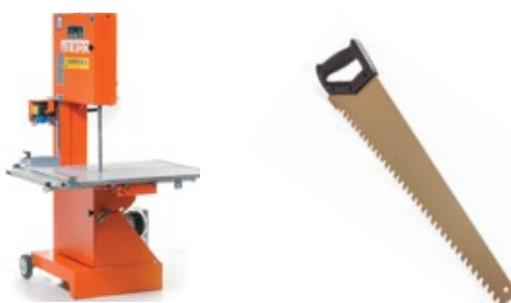
Ideato per tagliare i blocchi bauroc direttamente in cantiere. La sega a nastro è disponibile in due versioni: modello MBS 650 con l'altezza di taglio da 650mm e modello MBS 510 con l'altezza da taglio da 510mm.
