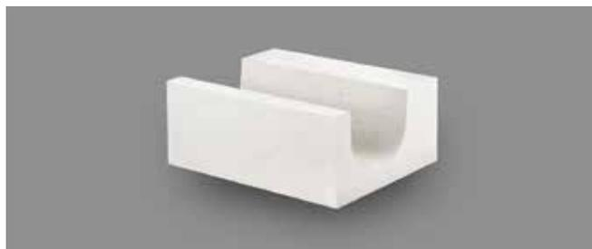
U-SCHALEN werden zum Gießen von Ringankern zur Versteifung von Gebäuden und als Verstärkung unter den Deckenbalken oder Deckenplatten verwendet. U-SCHALEN sind auch für das Gießen von Betonstürzen auf der Baustelle geeignet. In diesem Fall funktioniert die U-Schale als Schalung und beim Planen wird von allgemeinen Vorschriften für die Projektierung von Stahlbetonkonstruktionen ausgegangen.
