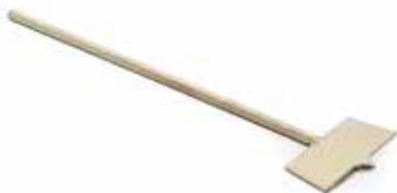
Wird zum Bohren von Löchern für Steckdosen und Schalter benutzt. Ermöglicht auch das Bohren von Löchern für die Durchführung von Wasser- und Lüftungsleitungen durch das bauroc MAUERWERK. Erhältlich mit einem Durchmesser von 80 oder 120 mm.
