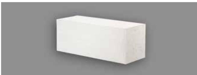
Im Unterschied zu den anderen bauroc Plansteinen haben die Planflächen eines UNIVERSAL Plansteins keine Nuten, sie sind also glatt. Dies ermöglicht, Plansteine sowohl stehend (Breite 200 mm) als auch liegend (Breite 300 mm) zu verbauen. Die Errichtung von 200 mm Wänden ist besonders effektiv – bei stehend verbauten Plansteinen beträgt der Materialbedarf nur 5,6 Plansteine/m<sup>2</sup>.
