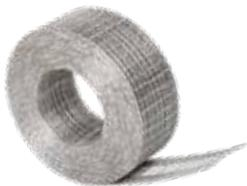
Murfor wird zur Verstärkung von Mauerwerk verwendet. Die Murfor® Compact-A-Gelenkverstärkung ist ein gewebtes Stahlnetz, das in Rollen geliefert wird. Eine Rolle enthält 30 m Verstärkung, die Breiten 40 und 80 mm sind verfügbar. Die Bewehrung der Wände ist nicht obligatorisch, aber wenn die Wände in Blöcken 3 m überschreiten, empfehlen wir die Verwendung der Verstaerkung, um die Bildung von Rissen zu verhindern. Wir empfehlen, die Bewehrung an jedem vierten Gelenk anzubringen.
