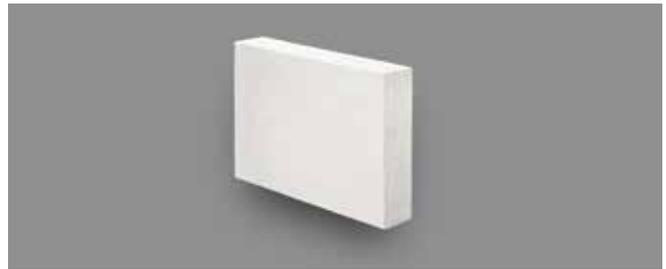
Die bauroc Planbauplatten sind für den Bau von nicht tragenden Trennwänden im Innenbereich vorgesehen. Durch ihre großen Abmessungen (400 x 600 mm) können Innenwände sehr zügig erstellt werden (nur 4,2 Planbauplatten pro m<sup>2</sup>). Da alle bauroc-Produkte feuchtigkeitsbeständig sind, eignen sie sich auch zur Abtrennung feuchter Räume.
